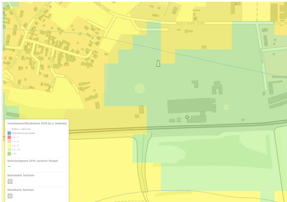
Abbildung 20: Grundwasserflurabstand 2016 (m. u. Gelände). Durch Aufschüttungen liegen weite Bereiche in einem Grundwasserflurabstand von ca. 5-10 m u. Gelände © iDA Sachsen
